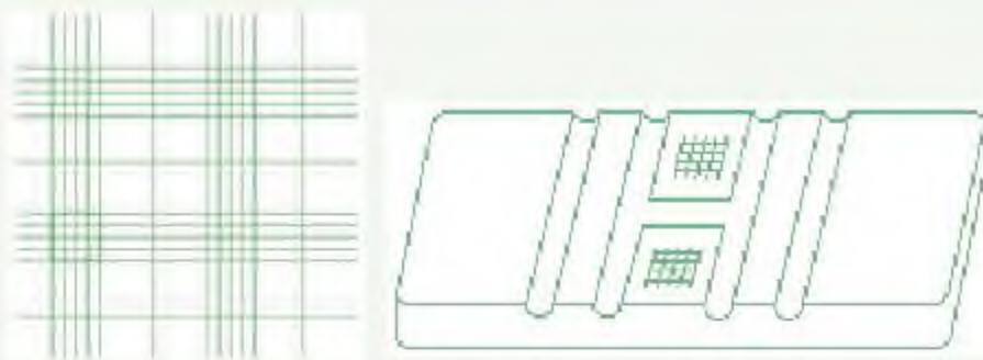
Рис. 4. Порядок определения цены деления винтового окулярного микрометра \delta
