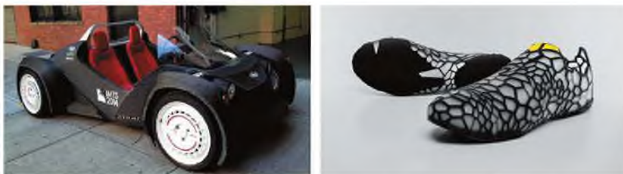
16.7-сурет. Автомобиль, аяқкиім бөліктерін басып шығару үшін 3D принтерді пайдалану мысалдары
