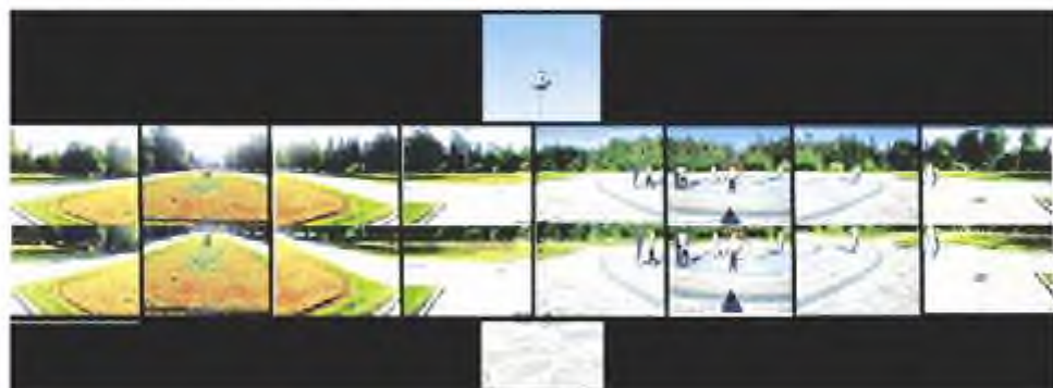
2.3.2-сурет. Кадрлар: 8+8+Z+N , екі қатар да горизонттан \pm 30^\circ көлбеумен түсірілген.
