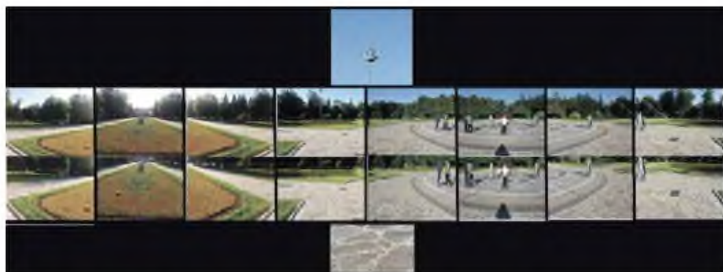
Рис. 2.3.2. Кадры: 8 + 8 + Z + N, оба ряда сняты с наклоном +/- 30° от горизонта
