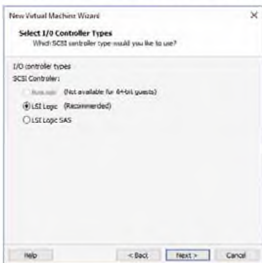
3.1.6-сурет. Енгізу/шығару контроллер түрін таңдау
