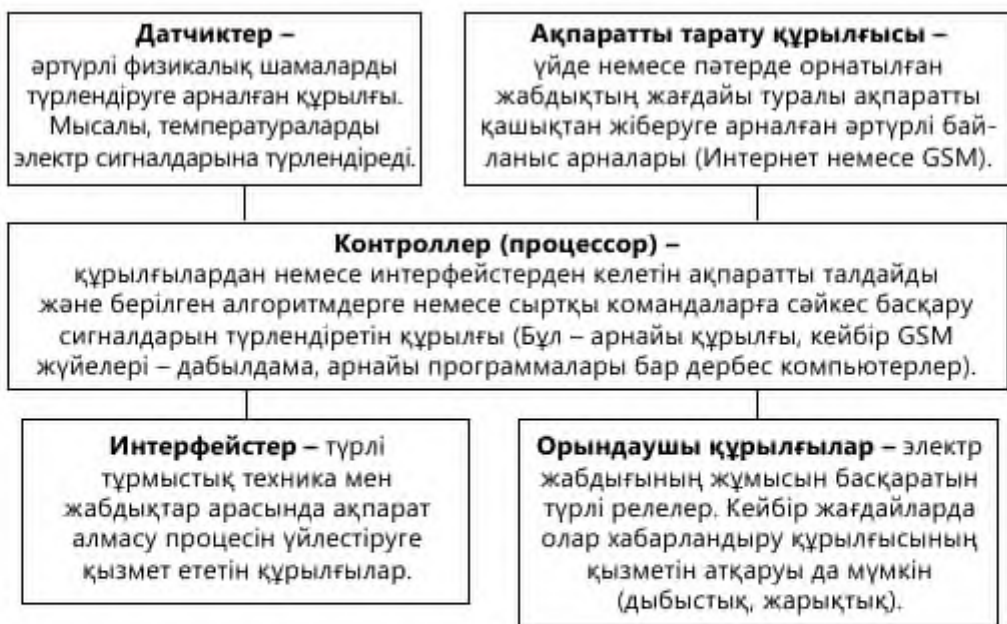
4.2.2-сурет. Құрылғының құрылымдық сызбасы және қызметтік мақсаты
