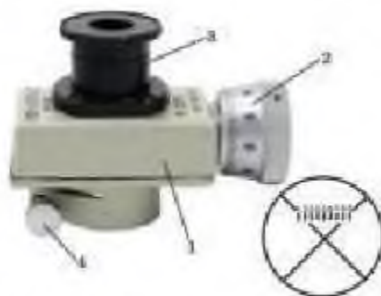
8.4-сурет. Окулярлық микрометр 1 — корпус, 2 — есептеуші барабан, 3 — диоптрийлі нысаналы окуляр, 4 — микроскоп тубусына бекітетін бұранда, 5 — микроскоп астындағы көрініс
