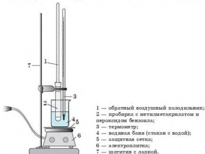
Установка для получения полиметилметакрилата
