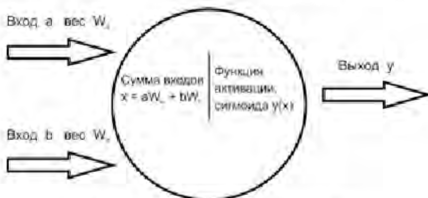
Рис. 1.4.3. Принцип работы нейронной сети
