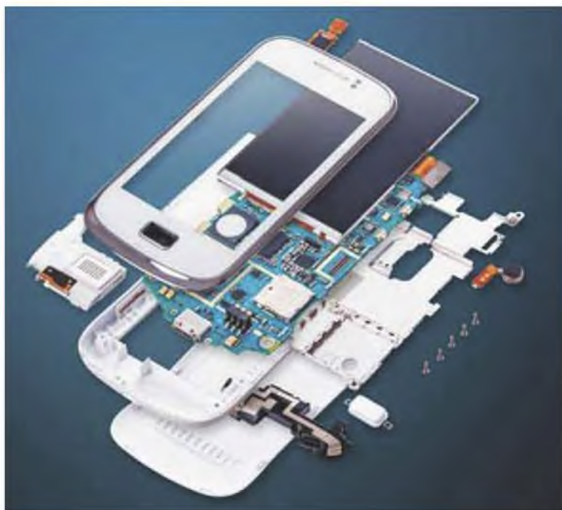
Рис. 54. Основные составляющие мобильного устройства
