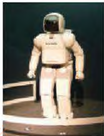
Шагающий робот-андроид ASIMO, производство Honda
